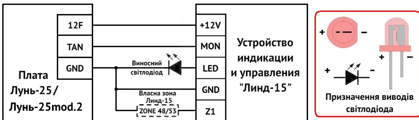
Малюнок 23. Схема під'єднання до ППК серії "Лунь-25"
