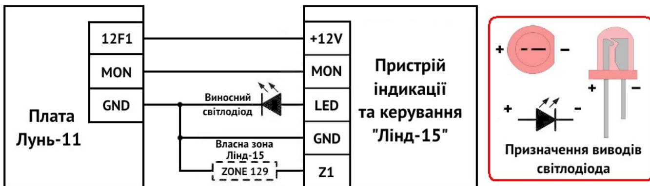
Малюнок 22. Схема під'єднання до ППК серії "Лунь-11"
