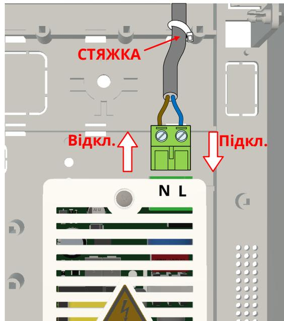
Рисунок 9 – Підключення та фіксація кабелю мережі 220В
