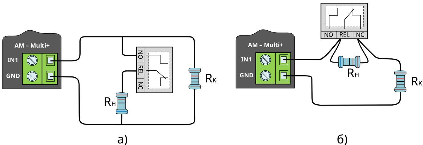
Рисунок 5 – Схема підключення входів IN
