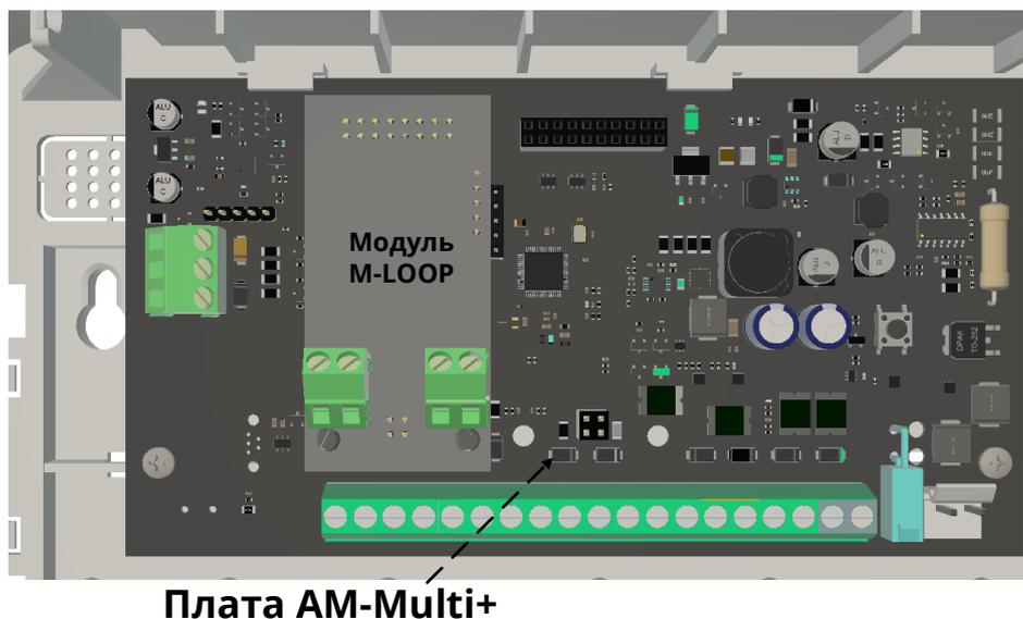
Рисунок 15 – Пристрій з встановленим модулем M-LOOP
