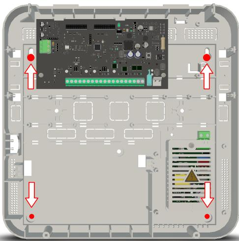
4. Прикласти корпус пристрою до стіни, вирівняти стан корпусу за допомогою будівельного рівня та намітити верхні 2 отвори. Просвердлити в намічених місцях отвори під дюбель. Встановити дюбелі, шурупи та навішати корпус. Діаметр отворів для навішування пристрою – 5мм.
