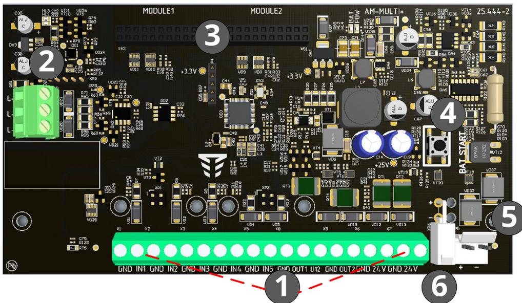
1. клеми підключення входів та виходів пристрою;
