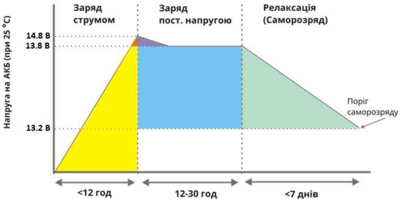
Рисунок 10 – Цикли роботи зарядного пристрою
