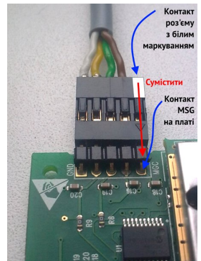
Малюнок 12. Під'єднання кабелю радіоприймача Visonic
