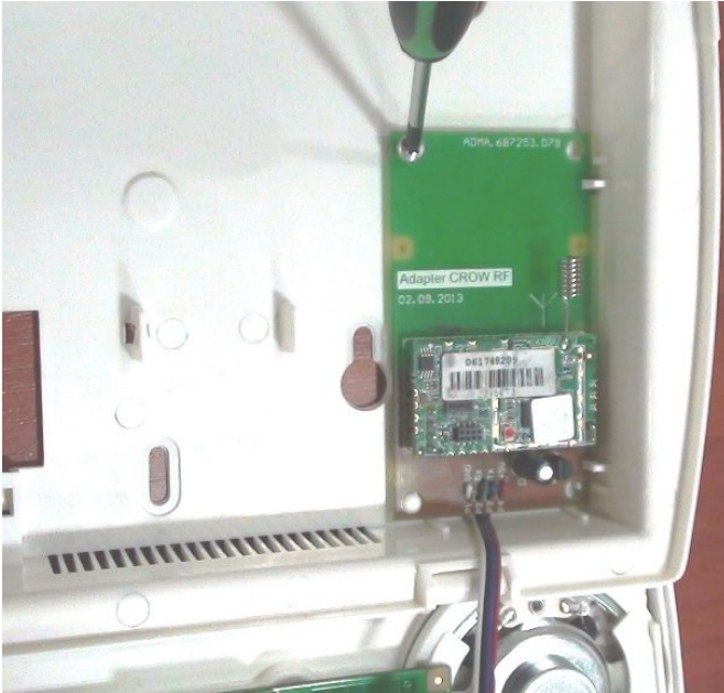
Малюнок 8. Встановлення приймача «CrowRF»
