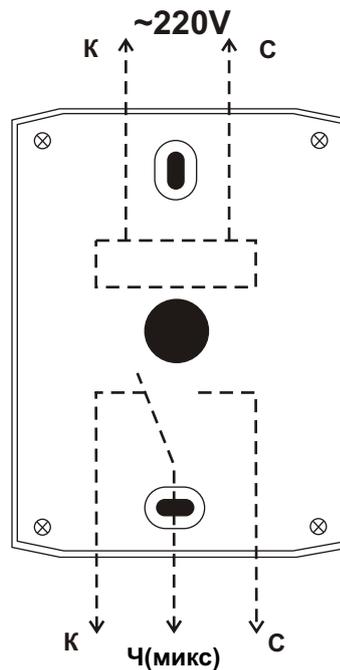
Кабель силового реле (трёхжильный)
