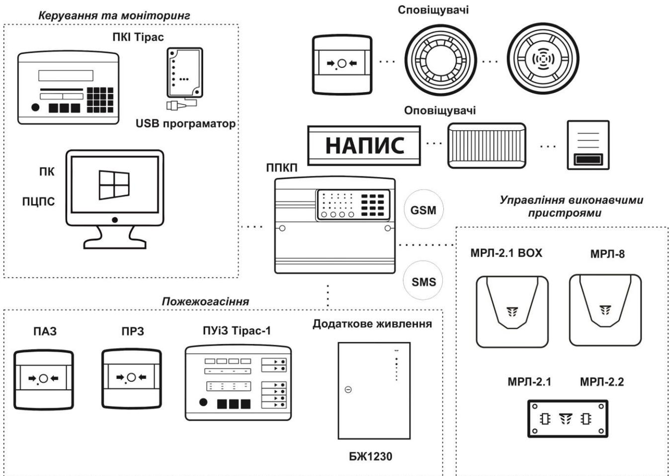
Рисунок 3.1 – Приклад компонентів системи пожежної сигналізації
