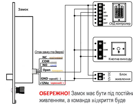
**ОБЕРЕЖНО!** Замок має бути під постійним живленням, а команда відкриття буде подана через контакт між помаранчевим проводом (OPEN) і чорним проводом (GND).
