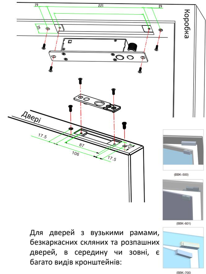
Для дверей з вузькими рамами, безкаркасних скляних та розпашних дверей, в середину чи зовні, є багато видів кронштейнів:
