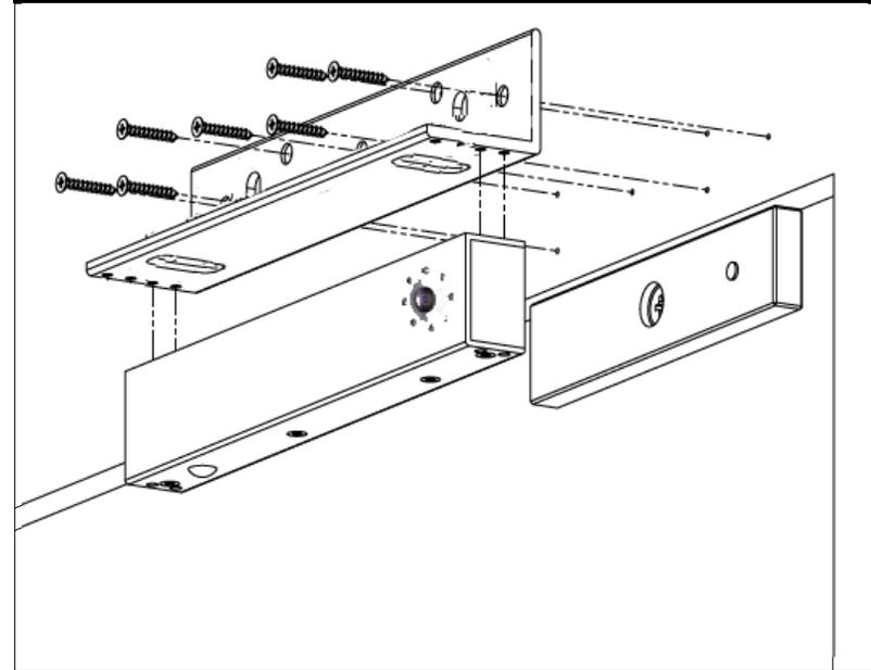
1. Прикріпіть кронштейн до корпусу електромагнітного замка за допомогою двох гвинтів.
