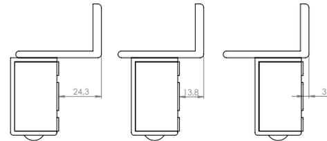
Використовуючи різні пари отворів кріплення замку на кронштейні, можна регулювати прилягання замку до дверей (відповідної планки)
